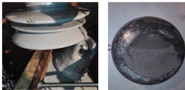
图 5 振动疲劳破坏的典型外观 (厂家 1)
