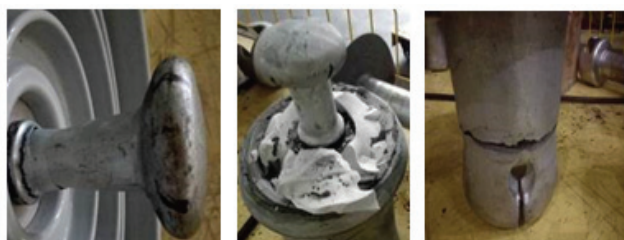
图 8 未疲劳绝缘子机械破坏外观
